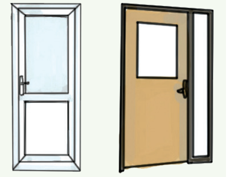
പി.വി.സി. ഹെഡ്മുളള വാതിൽ (PVC door) തടിവാതിലുകൾ കട്ടിയായി നന്നായി ഉറപ്പിക്കുക (Wooden door should be fixed properly).
