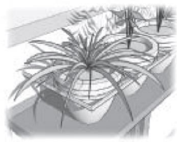
Figure 122 സുരക്ഷിതമായി ഘടിപ്പിച്ച വാട്ടർ ടാങ്കും ചെടിച്ചട്ടികളും സ്രോതസ്: An Earthquake Preparedness Guide: A Ready Reckoner for Home Dwellers
